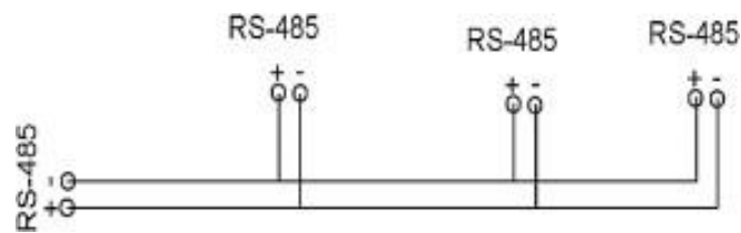
Figura 2.16. Red half duplex en RS-485 [2].
