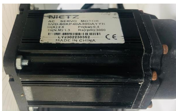
Figura 3.29. Especificaciones del servomotor NIETZ.
