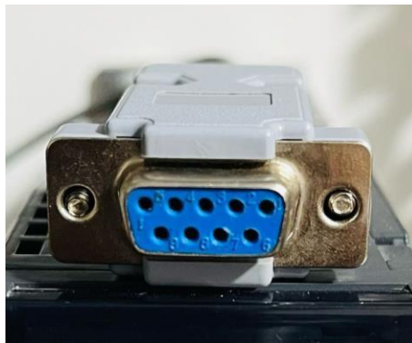
Figura 2.13. Conector hembra RS-232 (9 pines).
