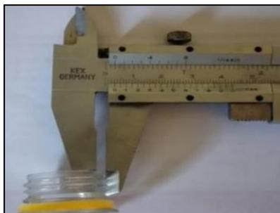
**Figura 4.3.** Medida del espesor en el pico de la botella
