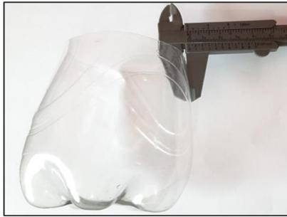
**Figura 4.4.** Medida del espesor en la lámina de la botella
