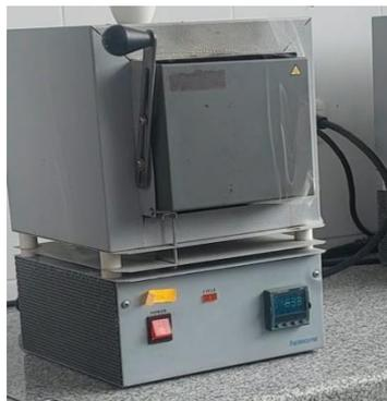
*Figura 8 Mufla a temperatura de 550°C (Marroquín y Pilataxi, 2023)*
