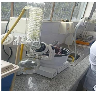
*Figura 14 Introducción de la muestra en el ROTAVAPOR (Marroquin y Pilataxi, 2023)*
