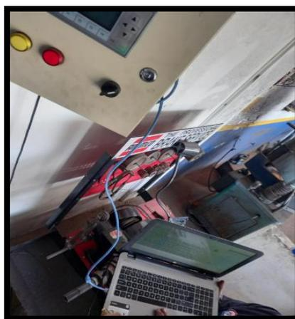
Fig. 9 Subiendo configuración del programa Logo Soft Confort al PLC - Logo 230RC
