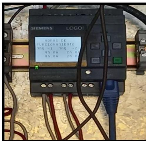
*Fig. 4. 28 Cargo de la programación en el PLC*
