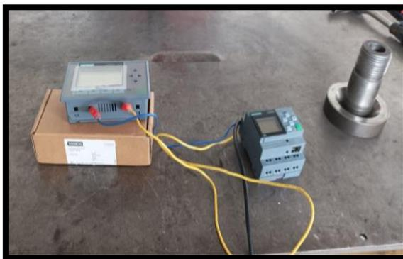
*Fig. 4. 25 Conexión de pantalla TDE con PLC - Logo*
