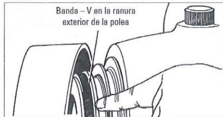
Figura 24 – Ajuste de posición de la banda
