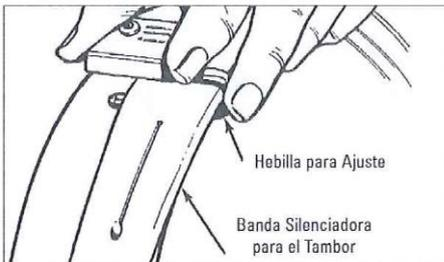
Figura 11 – Ajustar Banda Silenciadora
