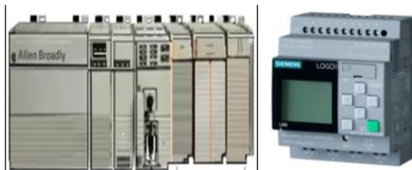
Fig. 3. Controladores Lógicos. (a) Modular. (b) Compacto. [12]
