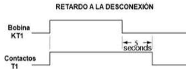
Figura 7: Diagrama de tiempos del retardo a la desconexión
