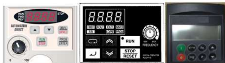
Figura 15: 3 consolas de tres marcas diferentes de variador de frecuencia
