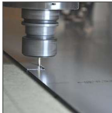
Figura 23: Trabajo con Alucobond
