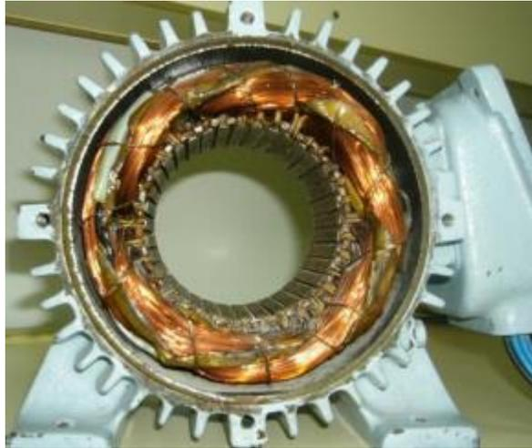
*Figura 2.3. Estator y Carcasa [4].*
