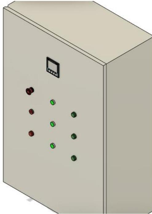
*Figura D.1. Implementación de luces piloto, Sentron Pac4200 y pulsadores, diseñado en Fusión 360.*
