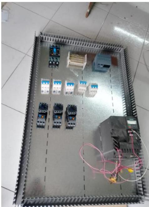
*Figura B.2. Implementación de canaletas ranuradas.*
