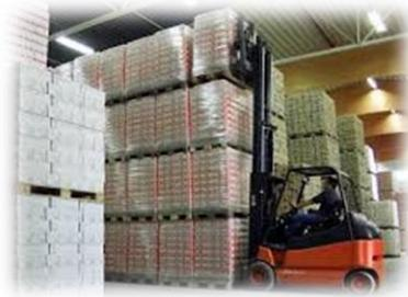
**Figura 2.10:** Almacenamiento en bloque o apilado. [28]
