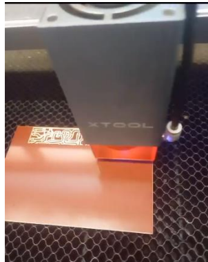
Figura 4.17 Elaboración de placa base mediante CNC Fuente: Grupo Investigador
