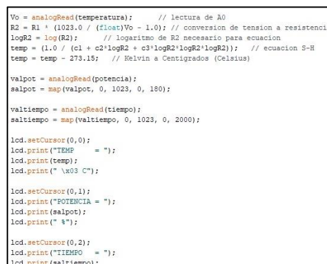
Figura 4.14 Programación de control de temperatura potencia y tiempo Fuente: Grupo Investigador
