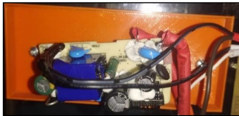
Figura 4.8 Fuente DC 5 (V) / 2 (A) conectada al módulo de control Fuente: Grupo Investigador
