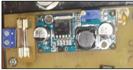
Figura 4.9 Fusible de protección para módulo de control Fuente: Grupo Investigador
