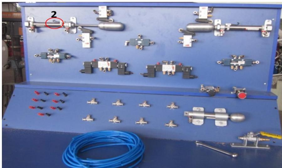
**Ilustración:** Sensor de proximidad magnético (1)
