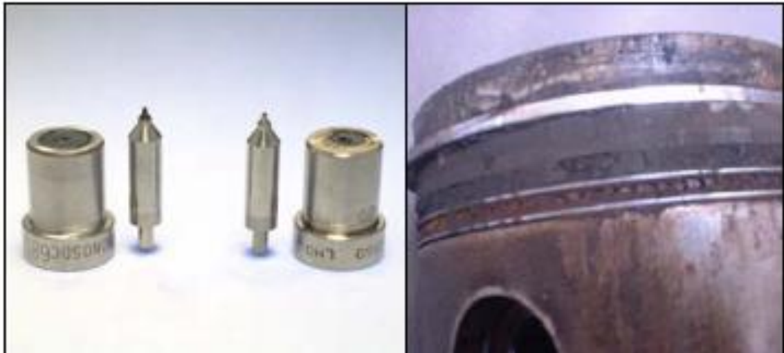
Figura1.4: Toberas de inyección, izquierda con azufre, Pistón y anillos sin movilidad, por oxidación a causa del azufre.
