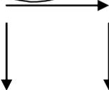
DIRECCIÓN de flujo o línea de unión, conecta los símbolos, señalando el orden en que se deben realizar las operaciones.
