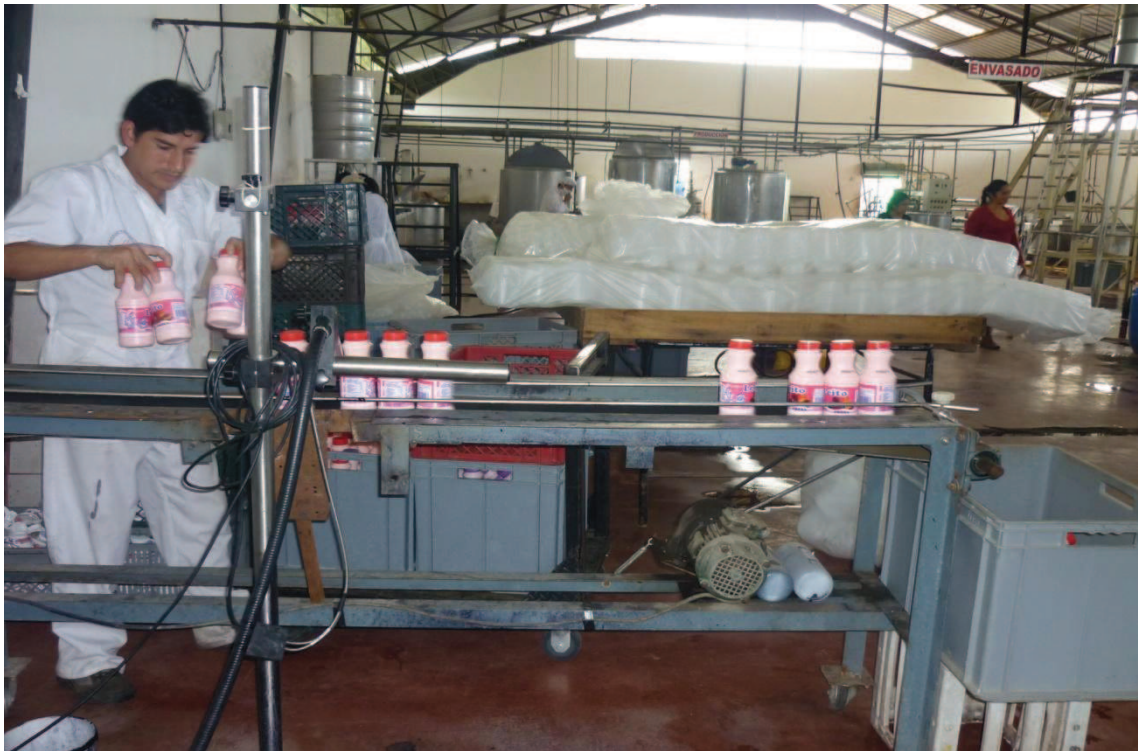
Maquina selladora y fechadora del producto terminado
