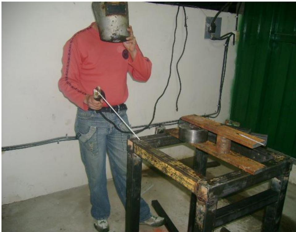
Unión del tubo mediante suelda
