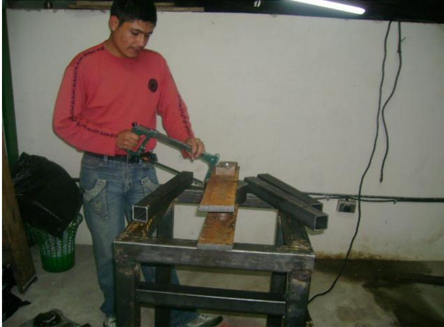
Corte del tubo para formar la estructura
