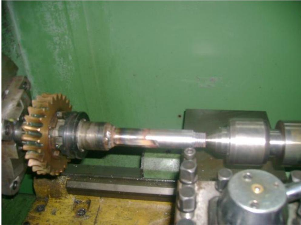
Mecanizando el eje mediante torneado
