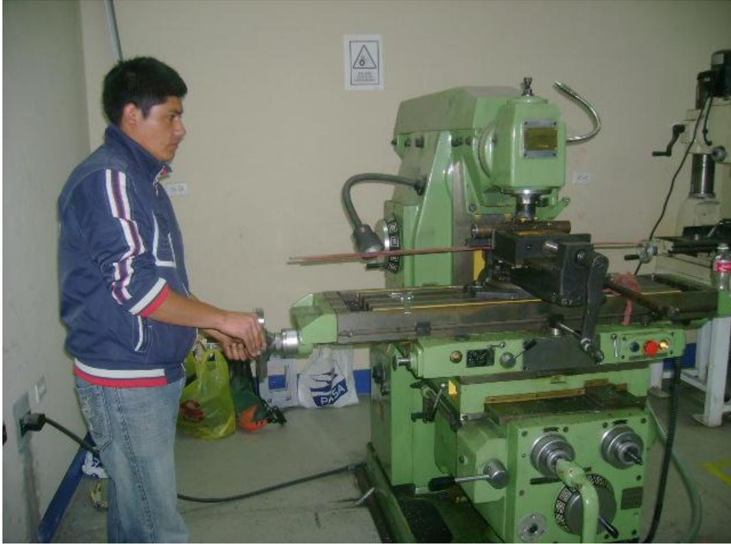
Mecanizado de la riel mediante el proceso de fresado
