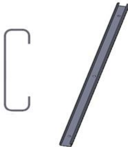
Fig. 3.3 Representación del modelo 3D del diseño de las correderas del prototipo de horno.
