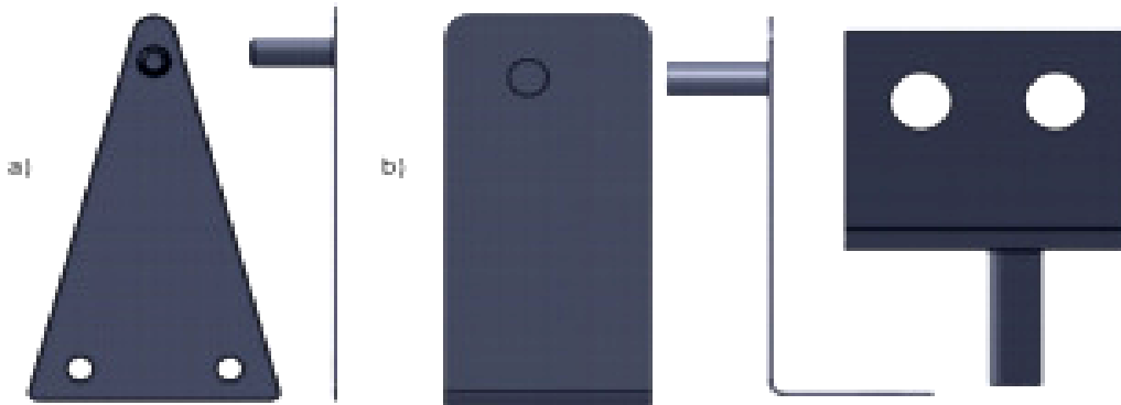
Fig. 3.9 Representación del modelo 3D de la base inferior y superior utilizada en el prototipo de horno.
