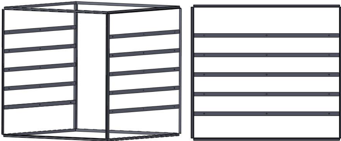
Fig. 3.2 Representación del modelo 3D de la estructura interior del prototipo de horno.
