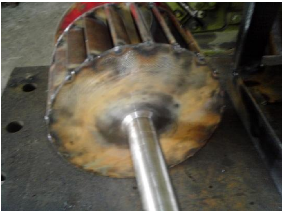
Soldadura de los álabes al rotor vista isométrica
