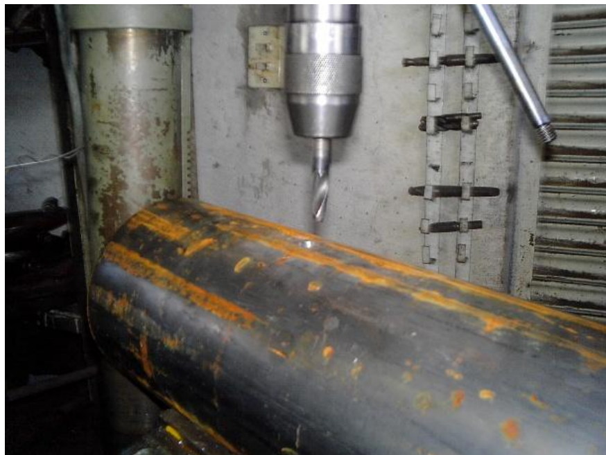
Orificio para la compuerta de entrada
