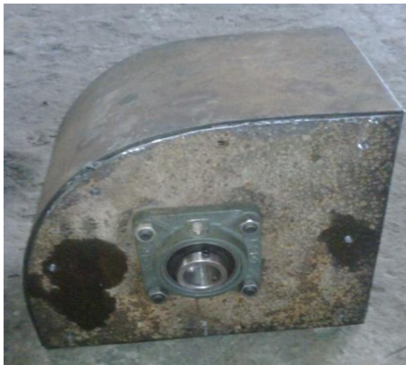
Colocación de chumaceras en la carcasa
