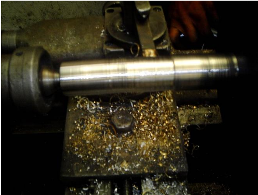
Construcción del eje del rodete vista frontal
