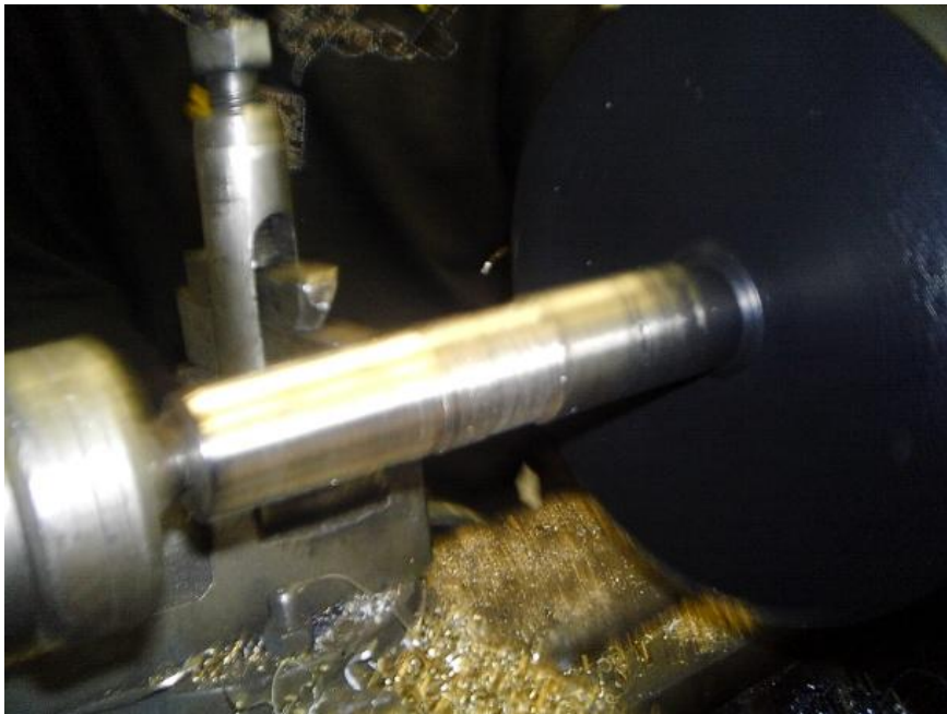
Construcción del eje del rodete vista lateral
