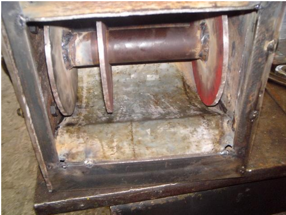
Turbina dentro de la carcasa
