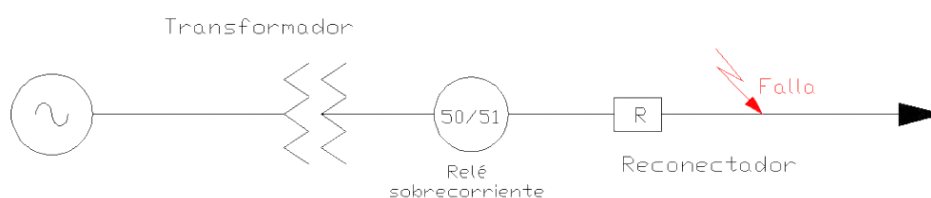
FIGURA 16. COORDINACIÓN RELÉ – RECONECTADOR
