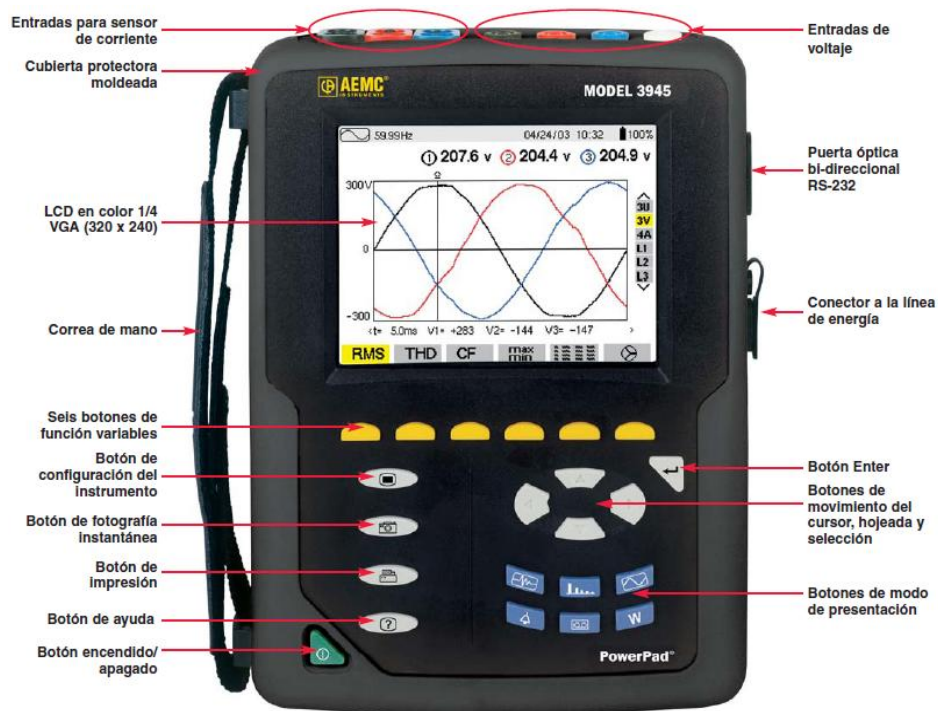
Figura 2.2. Partes constitutivas del analizador de energía POWER PAD 3945
