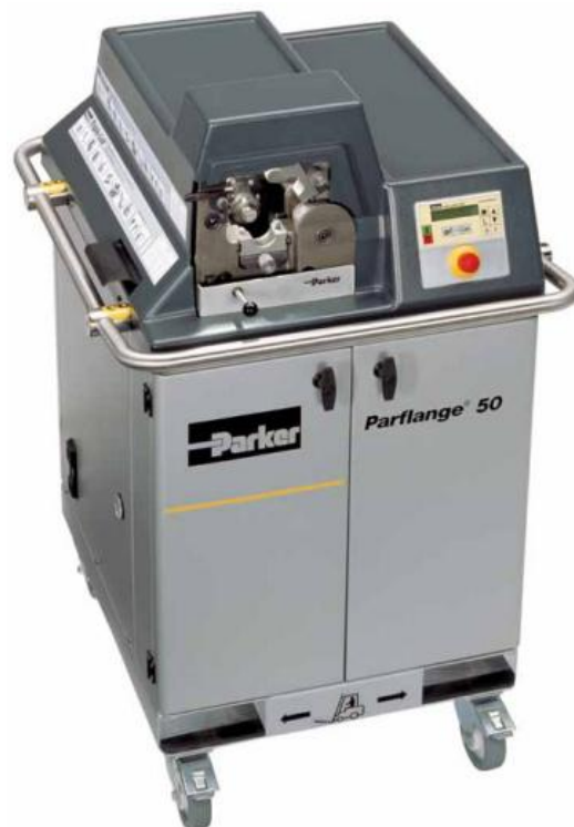
Fig. 1.11- Centro de trabajo para el abocardado en conexiones orbitales, O Lok y Triple O – Lok [Parker 2011].
