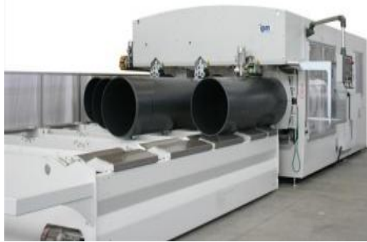
Fig. 1.10- Acampanado en línea para tubos de pp y pe [IPM 2010].
