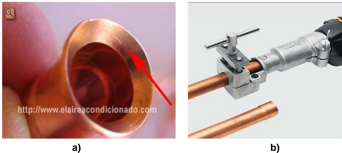
Fig. 1.1- Abocardado o expansión de tubos. a) abocardado. b) Expansión [Aires acondicionados 2011].
