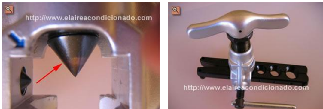
a) Fig. 1.3- Expansionador manual. a) Cono del expansionador. b) Expansionador [Aires acondicionados 2011].
