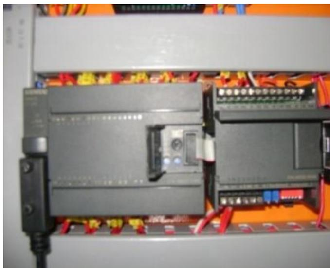
Fig. 3.41 Montaje PLC S7200 y Modulo de análogos EM 235
