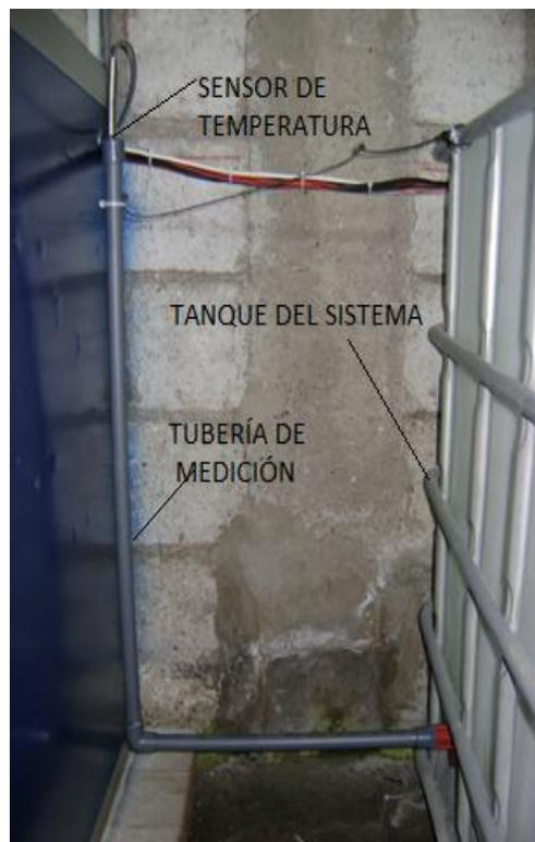
Fig. 3.34 Implementación de sensor de temperatura
