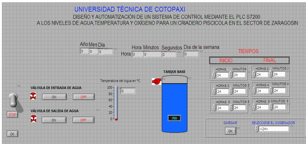
Fig. 3.89 Pantalla de visualización de control y monitoreo del sistema
