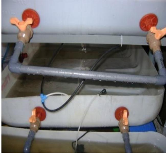
Figura. 3.30 Implementación de válvulas a bandejas de eclosión.
