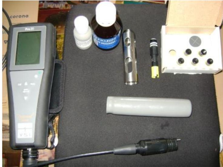
Fig. 3.36 Implementación de sensor de oxígeno
