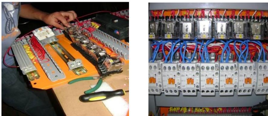
Fig. 3.39 Montaje de relés y contactores
