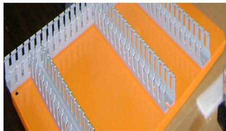
Fig. 3.38. Montaje de las canaletas para el tablero de control
