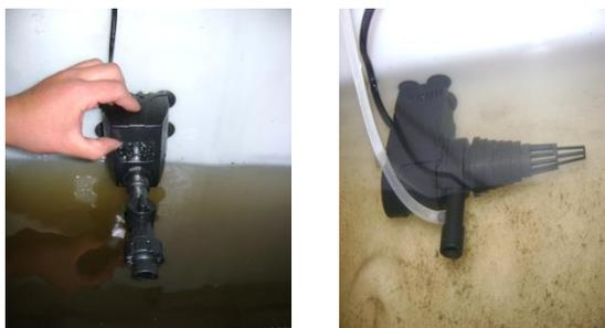
Fig. 3.33 Implementación de Oxigenadores en tanques y bandejas
