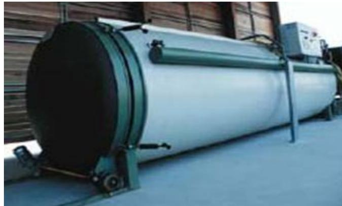
**Fig. 1.4** Secadora al vacío. [Www.Cismadera.Com/Downloads/Secadon11.Pdf, 2010]
