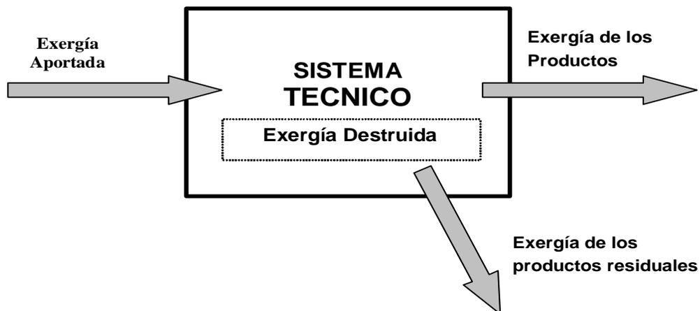
Fig. 2.1 análisis de las exergías de un sistema
