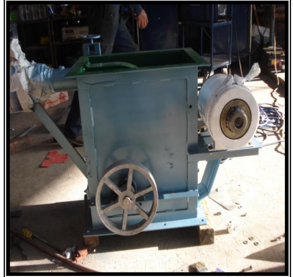
GENERADOR ACOPLADO A LA PICO CENTRAL HIDROELECTRICA
