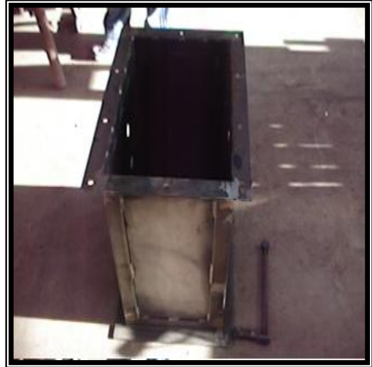
ESTRUCTURA METALICA PARA LA TURBINA MICHEL BANKI
