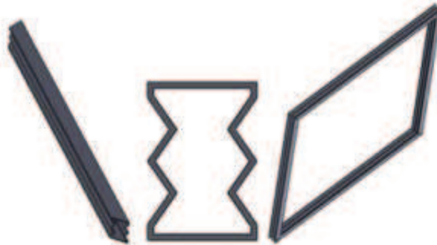
Figura 3.3. Representación del modelo 3D de la junta de la puerta utilizada en el prototipo incinerador para desechos hospitalarios.
