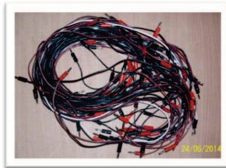
FOTOGRAFÍA 1.8. CABLES DE CONEXIÓN
