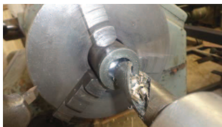
FIGURA 3. 60. CONSTRUCCIÓN DEL BOCIN
