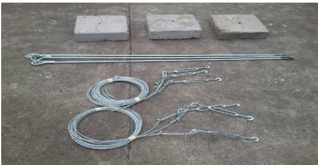
Figura 3.24. Material utilizado en los anclajes y tensores.
