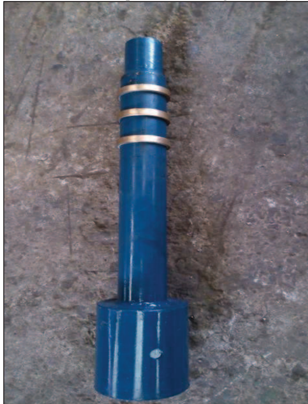
Figura 3.26. Tubo de acople entre el aerogenerador y la torre.
