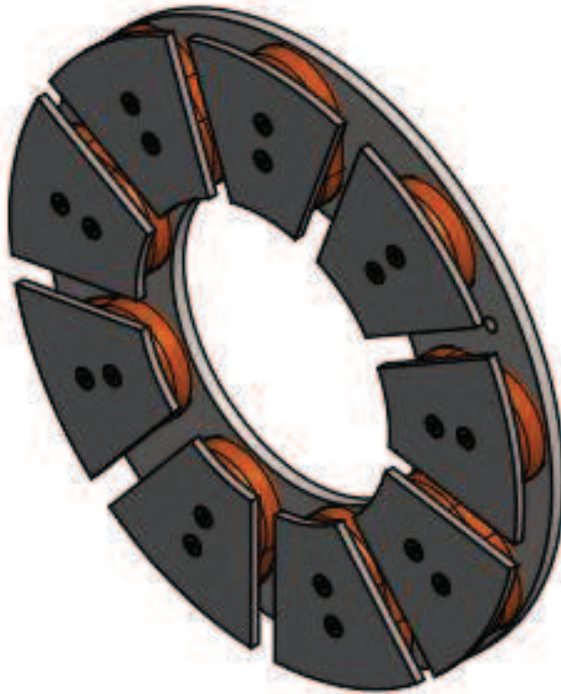
Figura 3.8. Vista modelada de las bobinas ensambladas.
