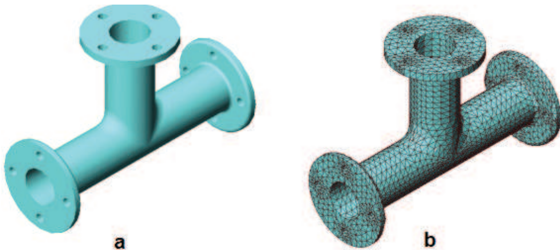
Fig. 2.3. Modelo CAD de una pieza a), mallado de este modelo b) [27].
