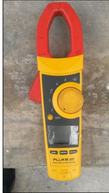
Pinza amperimétrica marca fluke 337
