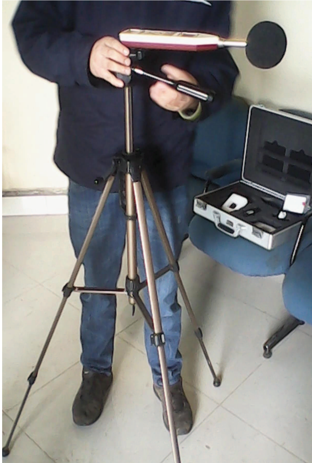
Ilustración 10: Colocación del sonómetro en trípode para evitar movimientos
