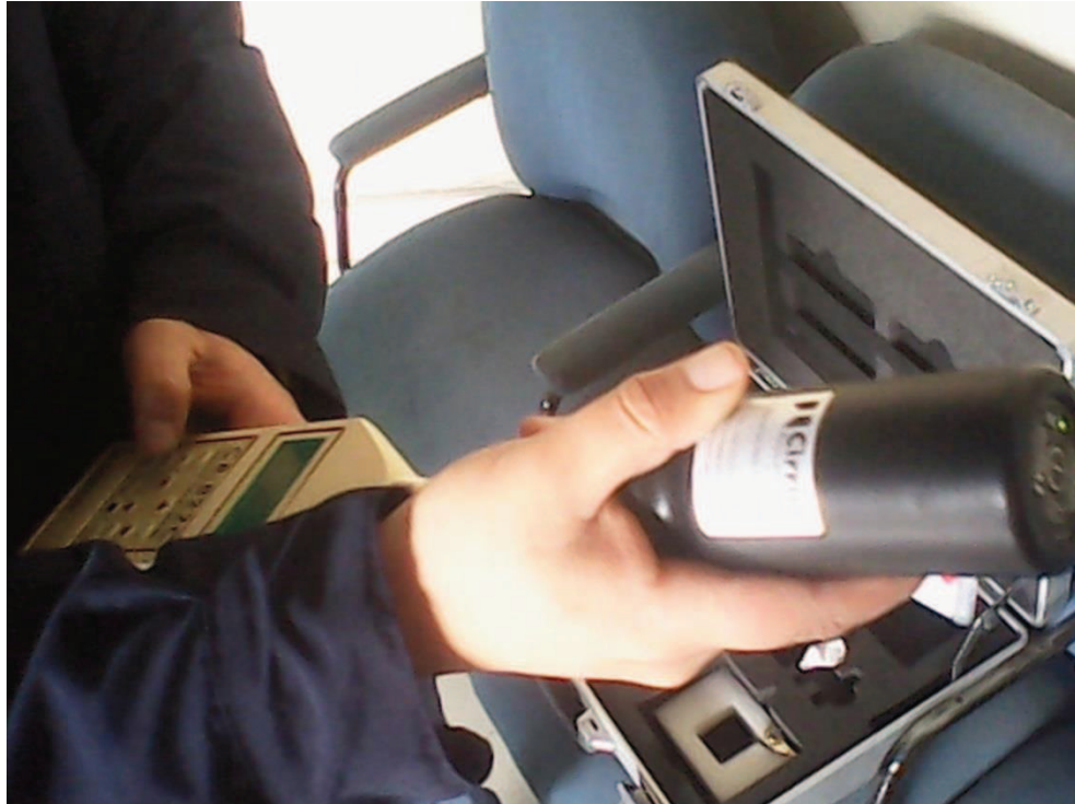
Ilustración 7: Calibración del sonómetro Elaborado Por: los investigadores.
