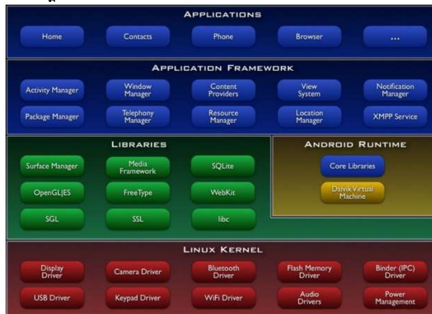
Figura 2: Esquema de la arquitectura de Android
