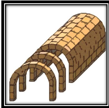
FIGURA N° 3.- BOVEDA DE CAÑÓN.
