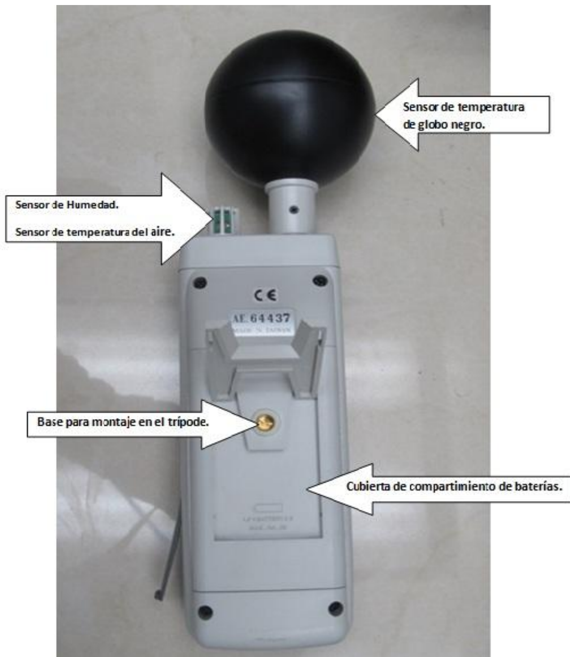
Figura N° 2.1 Medidor de estrés térmico vista trasera
