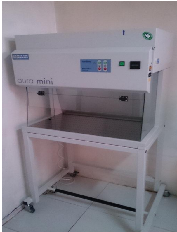
Ilustración 12. Cámara de flujo laminar aurora mini con base
