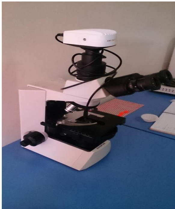
Ilustración 15. Microscopio Trinocular Olympus CX31 y Cámara científica INFINITY 1-2CB
