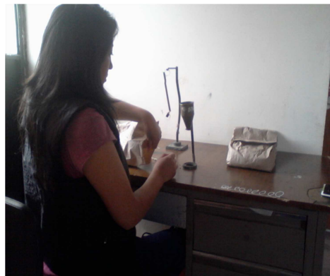
Determinación del peso hectolitrico en una muestra de 100 gr por tratamiento para las dos localidades.
