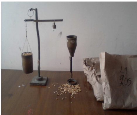
Determinación del peso hectolitrico en una muestra de 100 gr por tratamiento para las dos localidades.
