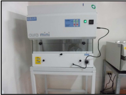
Cámara de flujo laminar
