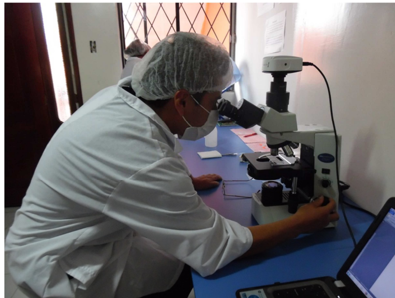
Fotografía 6. Observación al microscopio de las placas porta objetos, fotografiándolas con ayuda de la cámara científica instalada en el microscopio.
