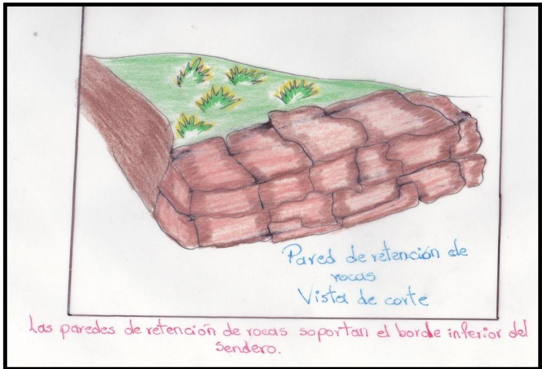
Las paredes de retención de rocas soportan el borde inferior del sendero
