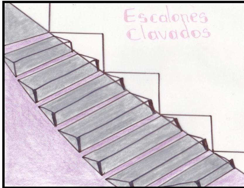
Escalones de madera asegurados a una pared de roca con varillas de acero
