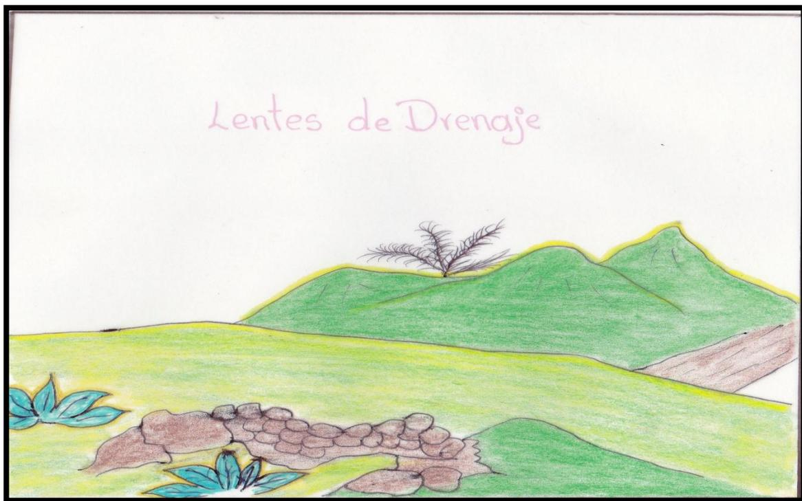
La instalación correcta de una lente de drenaje de rocas comienza con la excavación del sendero hasta que se llega a los suelos saturados. Generalmente esto implica excavar más allá del sendero, incluyendo algo del talud y del contratalud.
