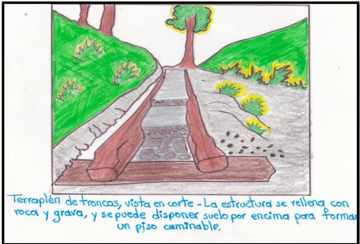
Terraplén de troncos, vista en corte - La estructura se rellena con rocas y grava, y se puede disponer suelo por encima para formar un piso caminable
