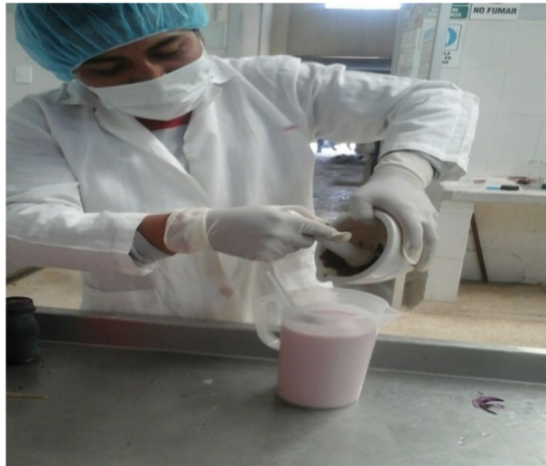
Fotografía 9. ADICIÓN DE FIBRAS.
