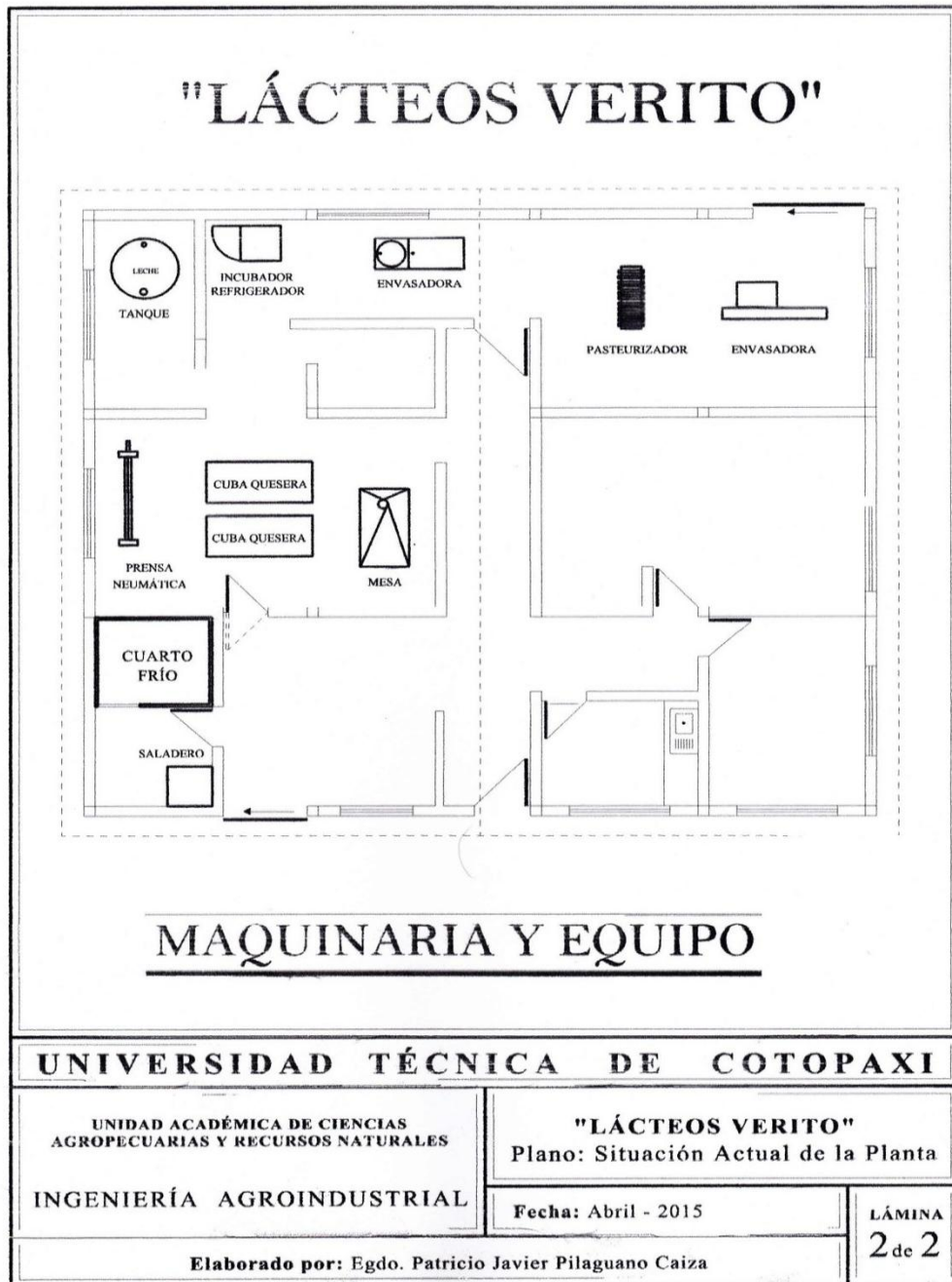
GRÁFICO N° 2: PLANO DE LA SITUACIÓN ACTUAL DE LA EMPRESA DE LÁCTEOS VERITO CON RESPECTO A LA UBICACIÓN DE MAQUINARIA Y EQUIPO
