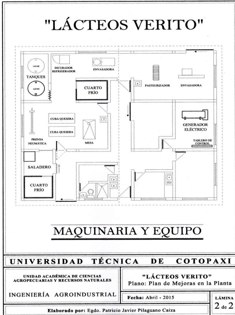
GRÁFICO N° 17. PLAN DE MEJORAS EN UN PLANO DE LA PLANTA DE PRODUCTOS LÁCTEOS VERITO CON RESPECTO A MAQUINARIA Y EQUIPO
