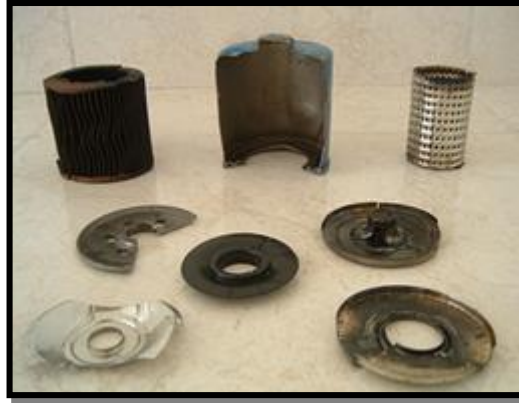
Gráfico N° 20: Componentes internos del filtro
