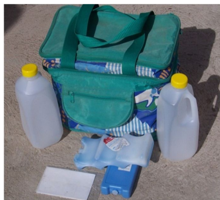
Materiales para muestreo ex situ: envases 2litros, sustituto de hielo, hielera y etiquetas
