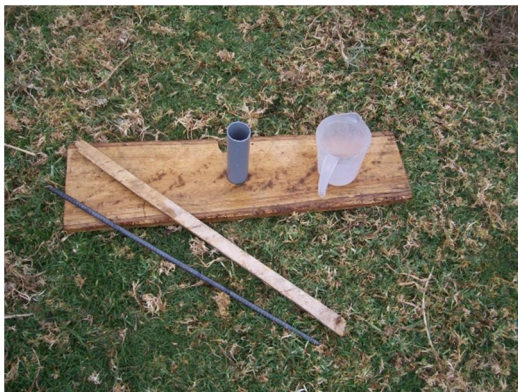
Materiales para la medición del caudal
