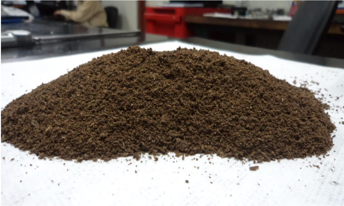
Cáscara de plátano micropulverizada utilizada en ensayo final de filtrado
