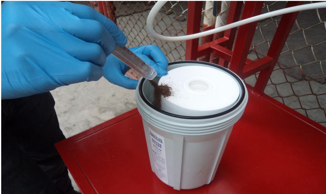
Colocación de cáscara de plátano en parte interna del filtro
