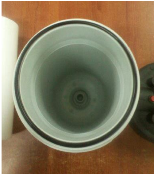
(Carcasa interna, carcasa externa, conexiones y filtro de polipropileno para mantener la cáscara de plátano en el interior.)
