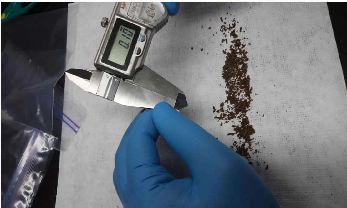
Verificación del tamaño de las partículas de la cáscara de plátano utilizada en ensayo final de filtrado
