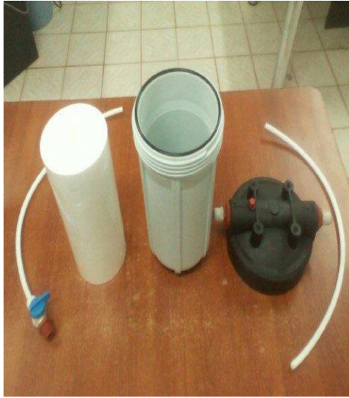
Partes del filtro utilizado como soporte fijo donde se colocó la cáscara de plátano
