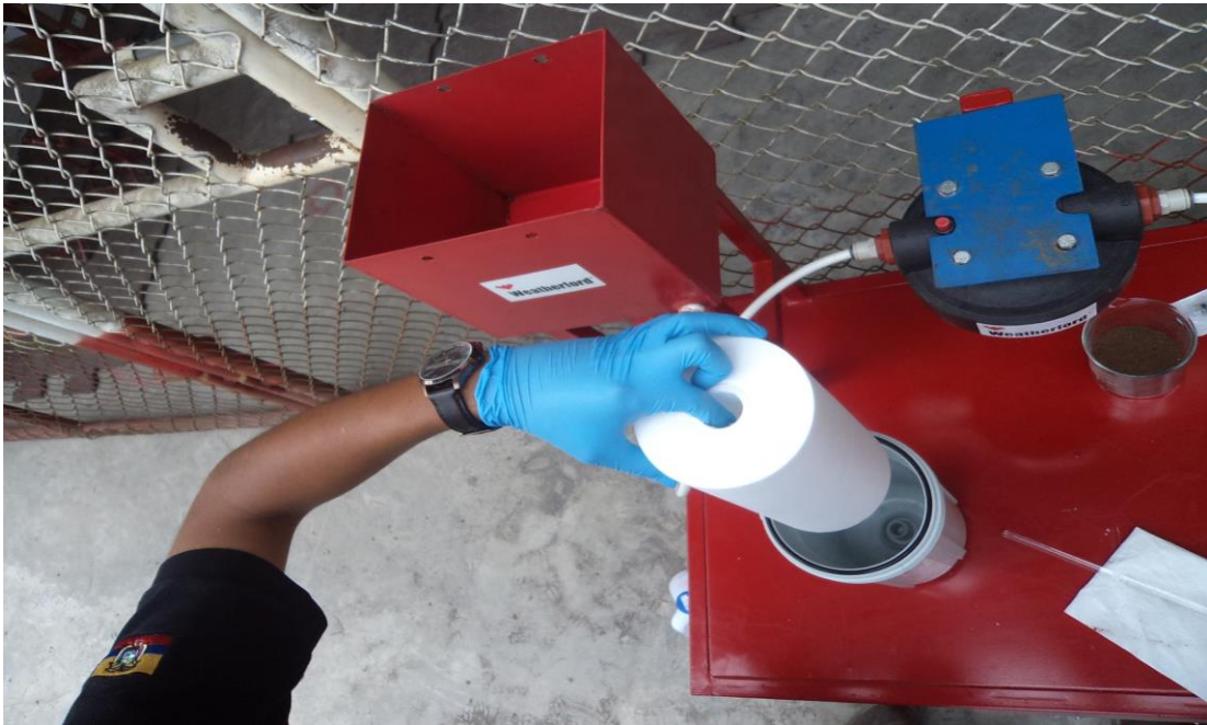
Armado de filtro utilizado en ensayo final de filtrado
