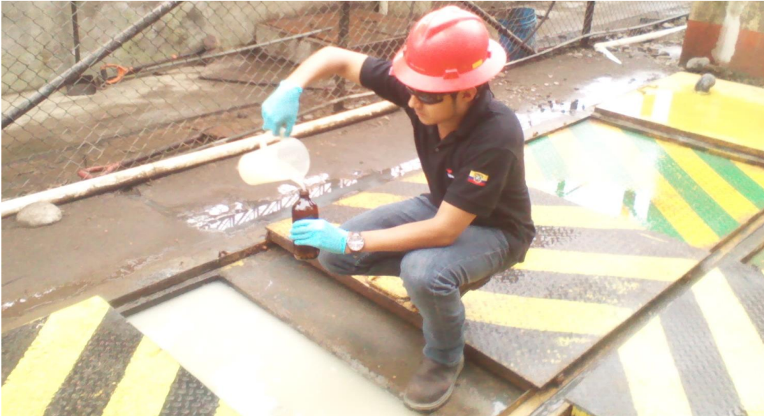
Muestreo de agua en planta de tratamiento de Base 2
