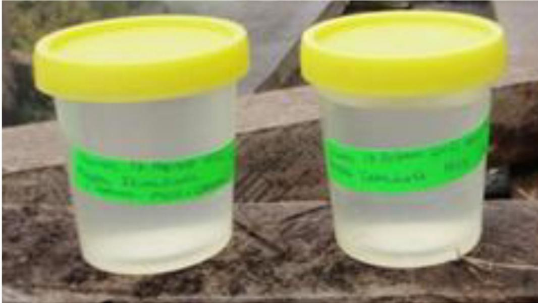
**FOTOGRAFÍA 6:** CONSERVA DE MUESTRA DE AGUA PARA EL TRASLADO HASTA EL LABORATORIO
