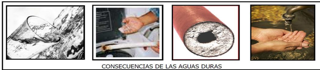
Los problemas causados por la dureza se presentan en los sistemas cerrados de distribución en donde se producen incrustaciones o corrosiones. En estos últimos tiempos estos problemas se han ido solucionando con la implementación de tuberías de plástico, las cuales no sufren estos problemas.
