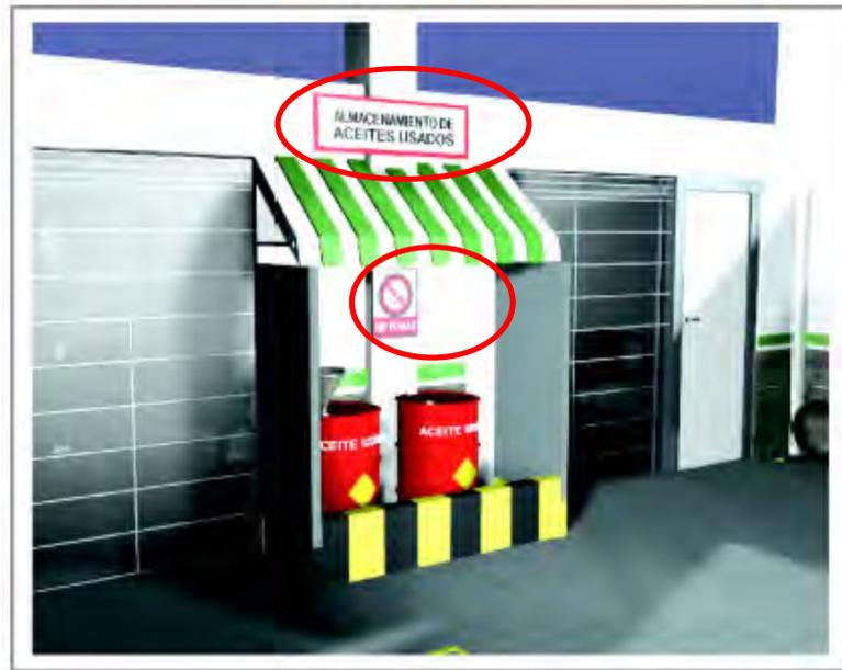
*Figura N° 10: Tanques superficiales de almacenamiento temporal de aceites usados.*
