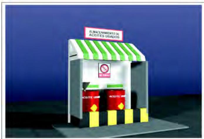
*Figura N°12: Cubierta del sistema de almacenamiento.*
