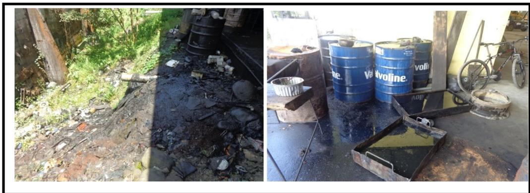
**Fotografía N° 11: disposición de aceites usados y filtros**
