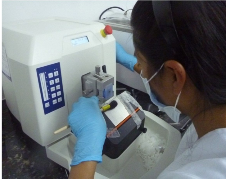
Fotografía N°21. Microtomo regulado a 5 um Laboratorio (Agro calidad)
