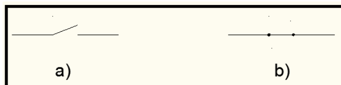
FIGURA 1.29 Representación de variables lógicas (a) variable directa (b) variable invertida
