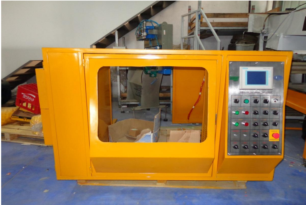
FIGURA 3.1 Estructura metálica compuesta por el circuito de potencia y de control
