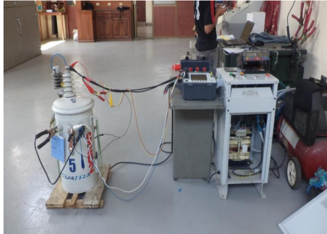
Conexión del transformador monofásico, Modulo de Pruebas y el PMM-1.
