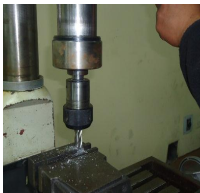
DESBASTADO Y AFINADO ACERO 760 PROCESO DE MECANIZADO EJE ACOPLE
