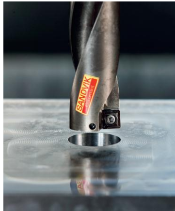
FIGURA N° 3.23. BROCAS PARA AGUJEROS PROFUNDOS EN MÁQUINAS CONVENCIONALES.
