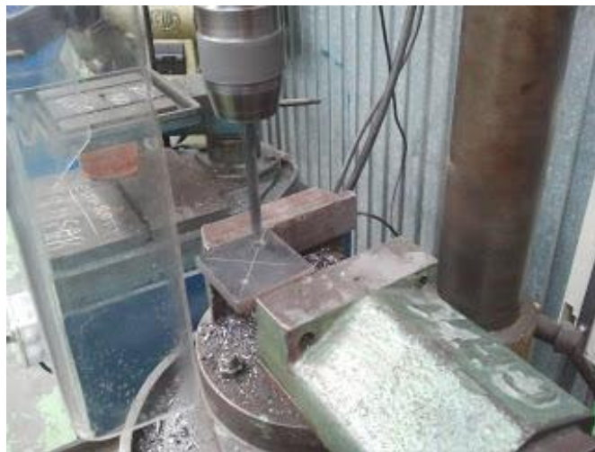
FIGURA N° 1.7 TALADRADO DE UN AGUJERO
