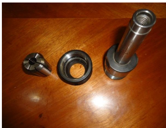
FIGURA N° 3.24. EJE CÓNICO CORTO ROSCADO Y PINZA
