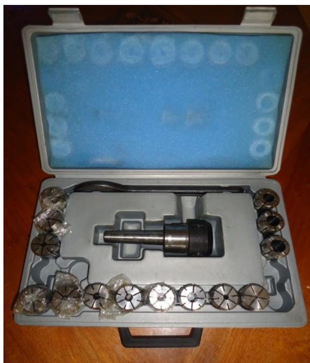
FIGURA N° 3.25. JUEGO DE 15 PIEZAS DE EJE CÓNICO CORTO ROSCADO Y PINZAS MILIMÉTRICAS.
