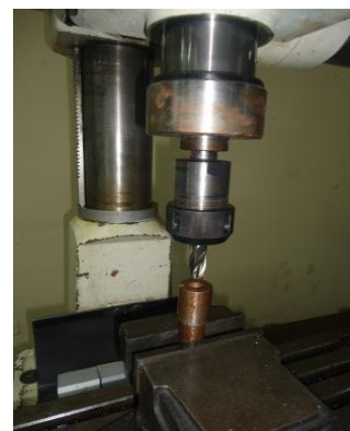
DESBASTADO Y AFINADO ACERO 760 PROCESO DE MECANIZADO EJE ACOPLE
