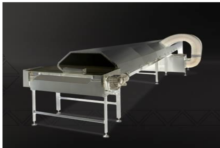
FIGURA 3. 3 Túnel de enfriamiento
