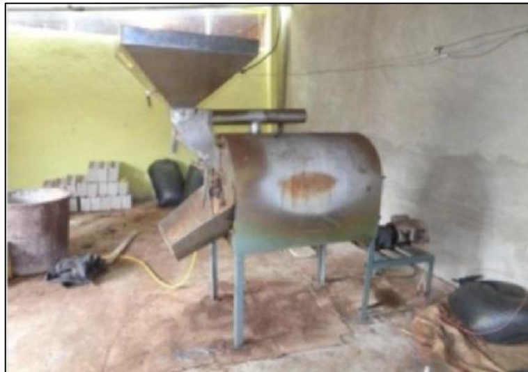
FIGURA 1. 2 Máquina tostadora de cacao
